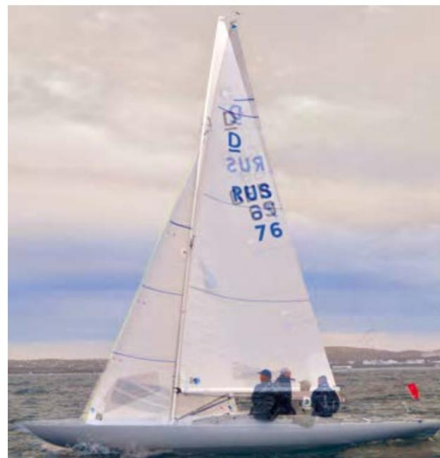
Zum Vergleich GER 69 und RUS 76 Team Samokhin mit unterschiedlichem Mastfall und Mastbiegung in der oberen Hälfte. Effekt: Öffnen des oberen Segeldrittels, ohne die Großschot zu fieren.
