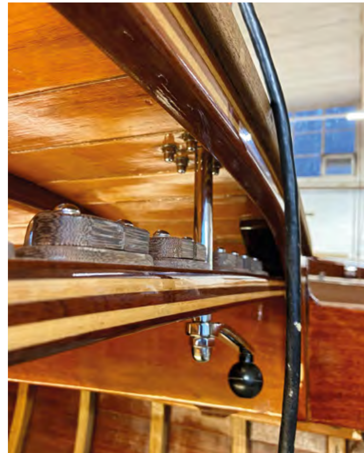
Oben: NESSIE erstrahlt in neuem Glanz. Der neu gebrachte 1K-Lack verspricht mehr Elastizität und sollte Risse im Freibord vorbeugen. Unten links: Spieglein, Spieglein an der Wand... Die originalen Andersen-Winschen verrichten ihren Dienst nach beinahe 50 Jahren noch einwandfrei. Unten rechts: Das Kajütendach war instabil geworden und musste ausgesteift werden. Durch einen neuen Träger erhielt die Konstruktion ihre Festigkeit zurück. Dazwischen die Achse der Spinnaker-Winsch, ein eher seltener Anblick bei einem Drachen.
